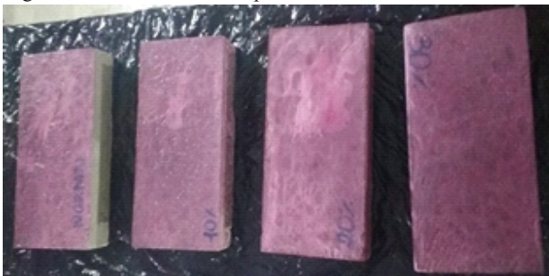
Figura 18 – Óleo Penetrante aplicado nos moldes de concreto
