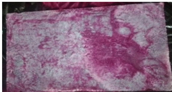
Figura 21 – Amostra sobre presença de óleo penetrante e revelador contendo 20% de calcite
