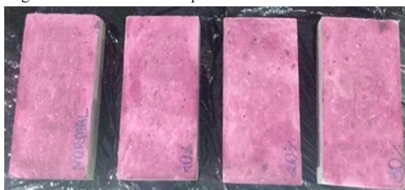
Figura 7 – Óleo Penetrante aplicado nos moldes de concreto
