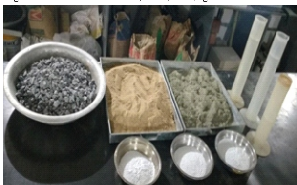
Figura 2 – Materiais: cimento, areia, brita, água e calcite.
