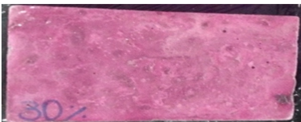
Figura 11 – Amostra sobre presença de óleo penetrante e revelador contendo 30% de calcite
