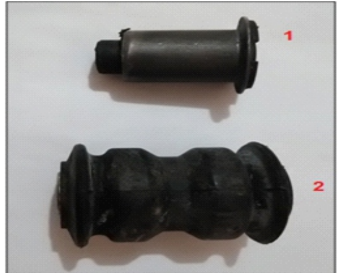
Figura 2- Bucha com centro e revestimento em metal (1); Bucha com centro em metal e corpo em borracha (2).
