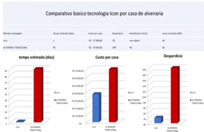
Figura 3 – Comparativo Básico da tecnologia Icon por casa de alvenaria estrutural cerâmica
